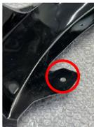
製品の仮合わせは、左図の8mm穴(左右とも)を基準とし、純正バンパーを固定しているM6ボルトを外し、本製品と共締めしておこなってください
